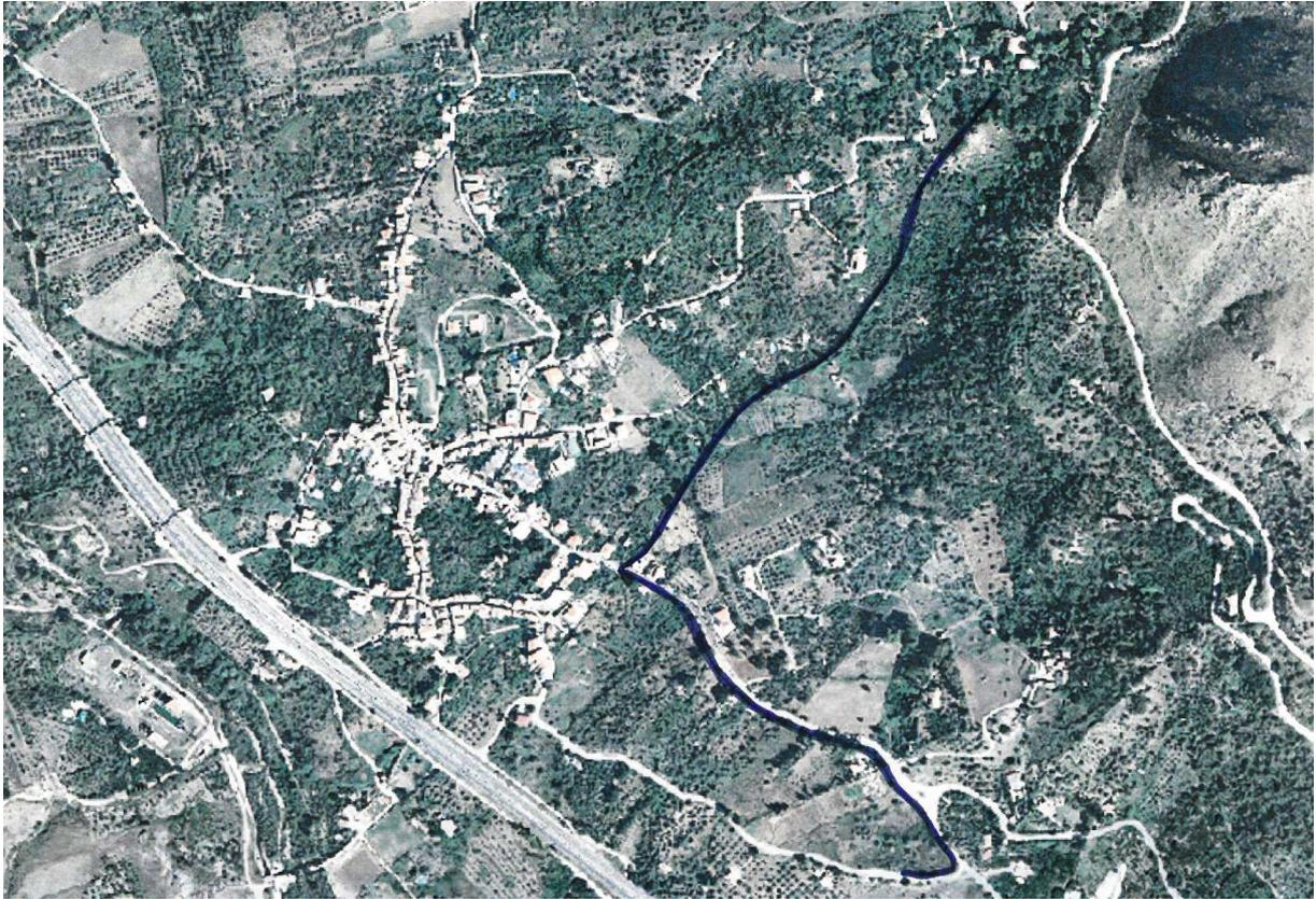
Planimetria (non in scala) con indicazione della presunta condotta dalle sorgenti all'area dell'impianto. Si fa presente che il sistema di approvvigionamento dalle sorgenti all'impianto avverrà per caduta e che la condotta così realizzata non darà luogo ad espropriazioni.
